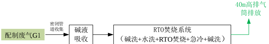
图 4.2.1.2-1 扩建项目废气收集处理示意图
